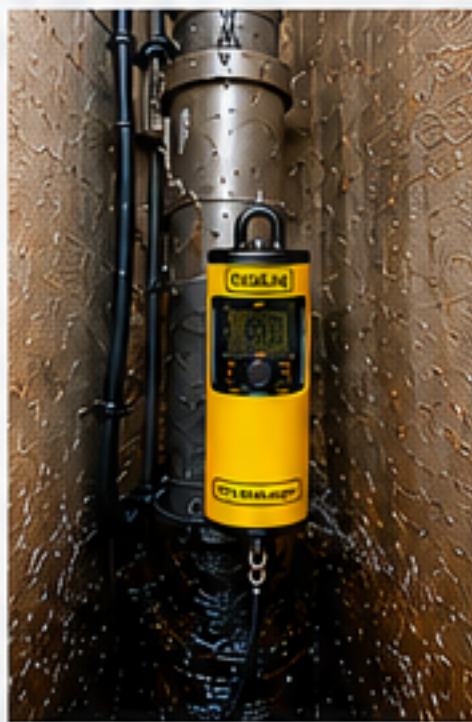
管路内や人孔壁面に設置
